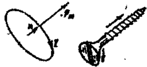
Рис. 7.1. Обертання головки гвинта в напрямку струму I зумовлює переміщення гвинта в напрямку вектора p_m
