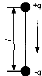
Рис. 5.1. Схема полярної молекули (диполя)
